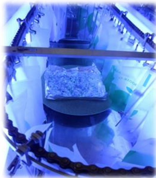
Figura 2. Vista interior de la cámara de intemperismo con los plásticos para tratamiento por exposición de luz
