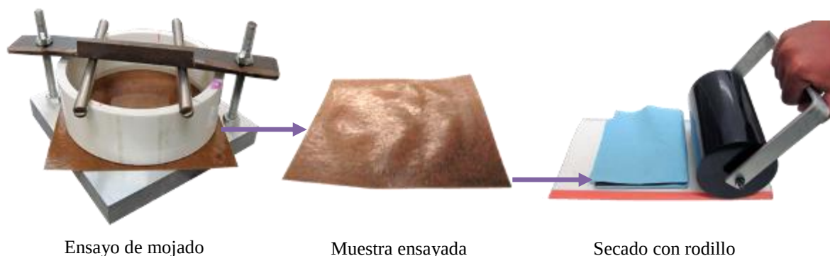
Figura 2. Proceso usado para la prueba de absorción de agua según TAPPI 441 om-09.
