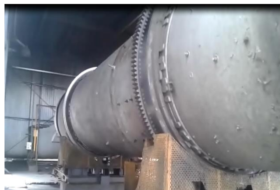
Figura 2. Horno industrial de Incineración de lodos
