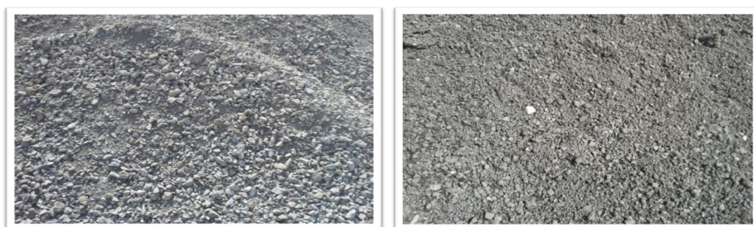
Figura 3. Izquierda arena y a la derecha grava, ambos elaborados con material reciclado.
