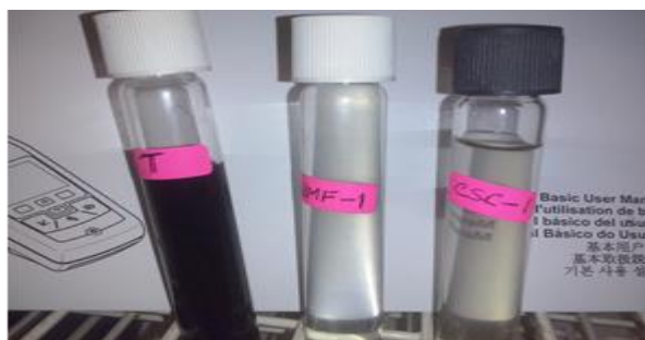
Figura 4. Muestra testigo y resultado de la filtración de la cáscara seca y fresca a 10 ml
