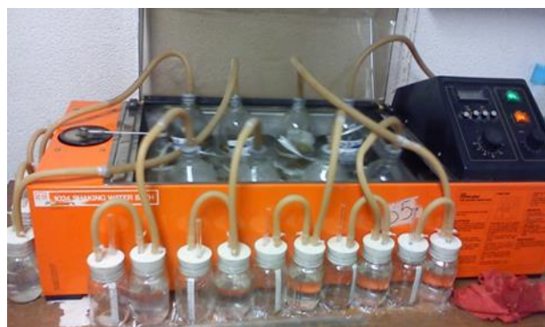
Figura 1. Biorreactores con sistema de medición de biogás
