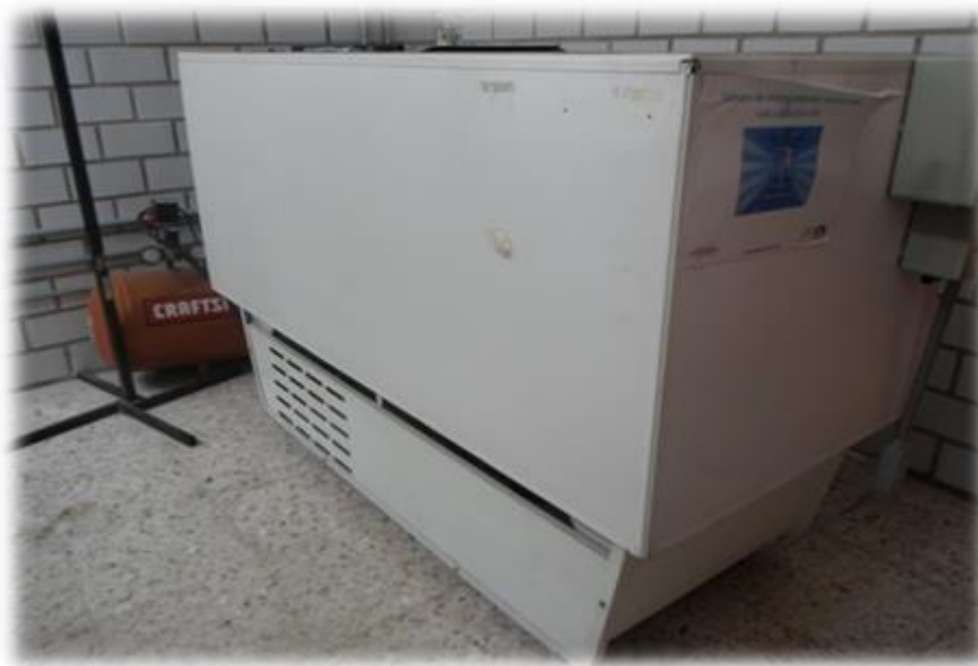
Figura 1. Aspecto exterior de la Cámara de Intemperismo
