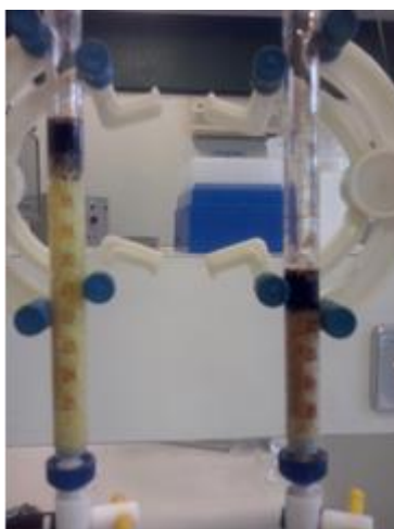
Figura 3. Columnas de adsorción (buretas) empaquetadas con cáscaras de naranja fresca y seca
