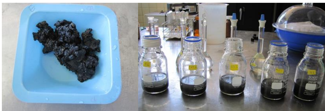
Figura 1. Lodos usados en las pruebas de biodegradabilidad del lixiviado.
