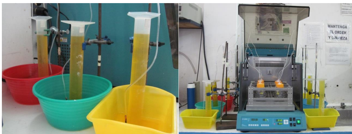
Figura 2. Arreglo del sistema de medición de biogás en las pruebas de metanización.
