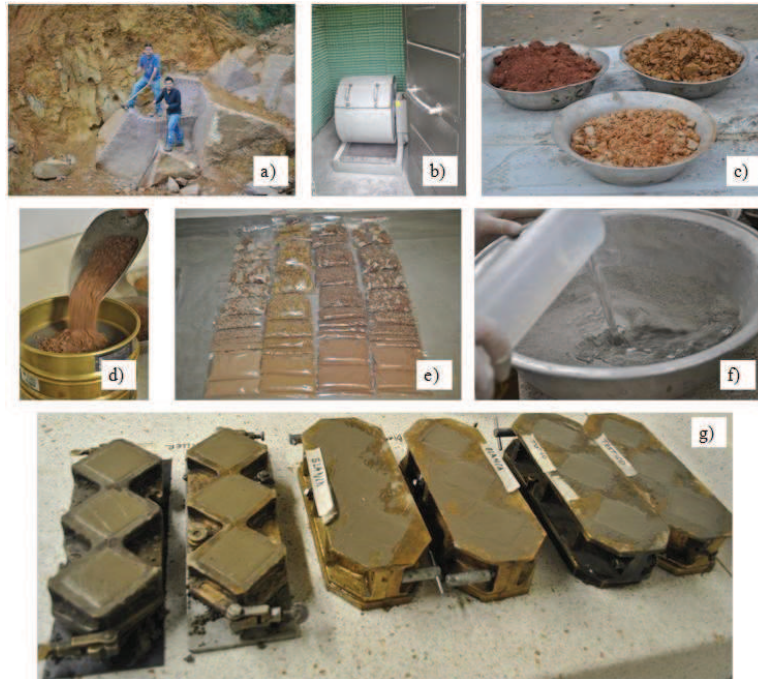
Figura. 2. Extracción manual de la piedra (a), ajuste del material (b), separación del material según canteras (c), granulometría (d), clasificación por tamaños (e), preparación de mortero (f), encofrado en moldes (g).
