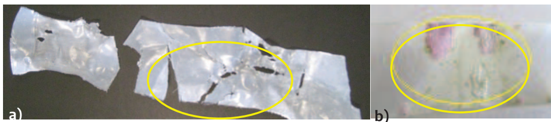
Figura 2. Ecovio® después de 30 días: a) sistema hidropónico (rasgaduras y deformaciones), b) ambiente marino (crecimiento de colonias)
