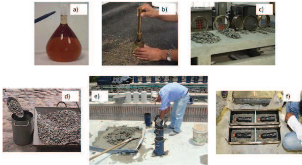
Figura. 1. a) gravedad específica del cemento, b) densidad de agregado fino y grueso, c) granulometría para identificación de tamaño máximo y módulo de finura, d) masa unitaria, e) mezclado, f) preparación de mampuestos con concreto
