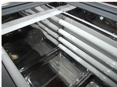
Figura 2. Lámparas UV montadas sobre una pared y recipientes para agua en el fondo
