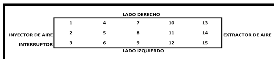
Figura 6. Puntos de medición de radiación UV-A en la cámara de intemperismo
