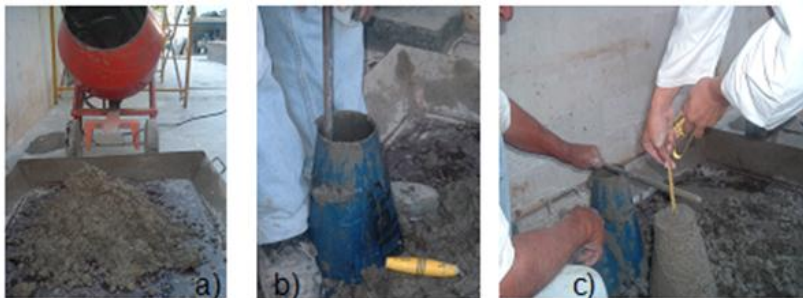
Figura. 3. a) Preparación de la mezcla de concreto, b) llenado y compactado 25 golpes distribuidos en tres capas de altura tercios cada capa, c) prueba de asentamiento
