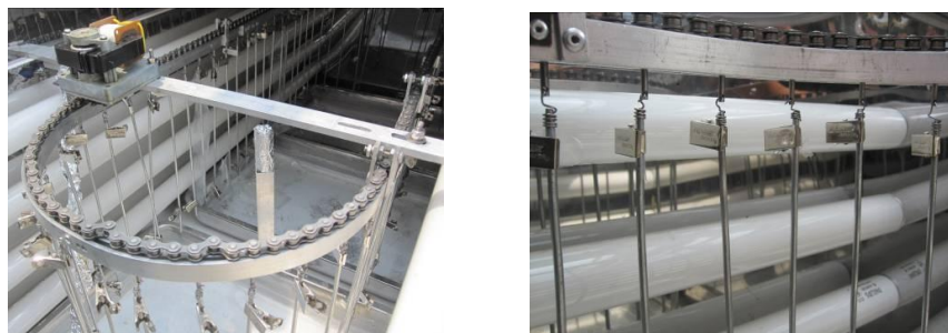
Figura 5. Sistemas de tracción (izquierda), varillas y pinzas para la sujeción de las muestras (derecha)
