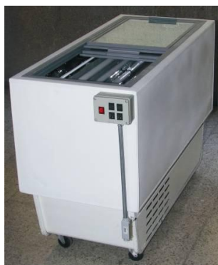
Figura 4. Tablero de control y puertas deslizables
