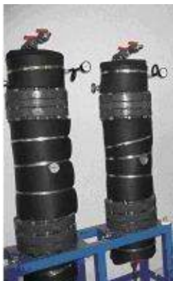
Figura 6. Biorreactores piloto montados.
