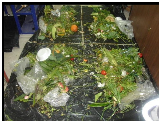
Figura 1. Homogenización de la muestra por Método de Cuarteo
