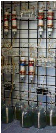
Figura 2. Biodigestores a escala laboratorio con recirculación de lixiviados.
