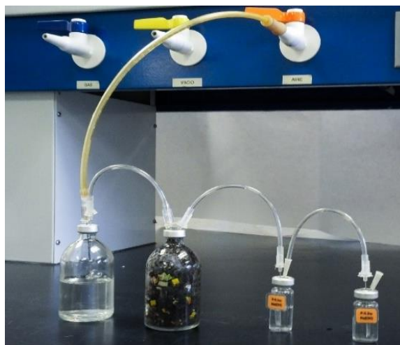
Figura 5. Montaje del sistema con aireación discontinua
