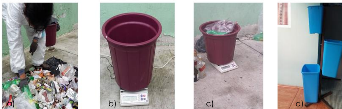
Figura 1. Métodos de muestreo y análisis de los residuos sólidos urbano: a) recolección y separación (Norma NMX-AA-15-1985), b y c) clasificación de subproductos y obtención del peso volumétrico (Normas NMX-AA-19-1985, NMX-AA-22-1985) y d) sistema de contenedor vertical.
