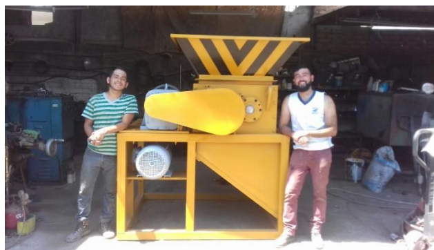
Figura. 5 Máquina trituradora de neumáticos.
