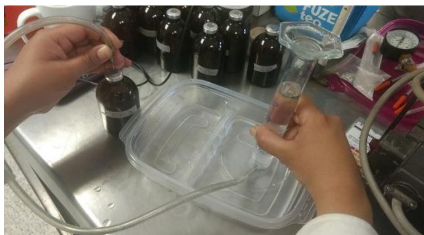
Figura 1. Medición del gas generado mediante desplazamiento de agua
