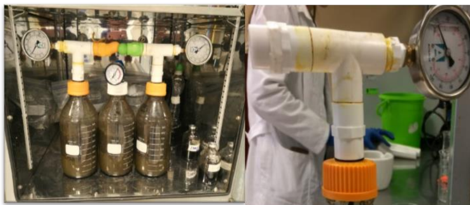
Figura 2. Derecha, digestores de 1,250 ml. Componentes adaptados a la tapa GL45 del reactor en frascos de cultivo
