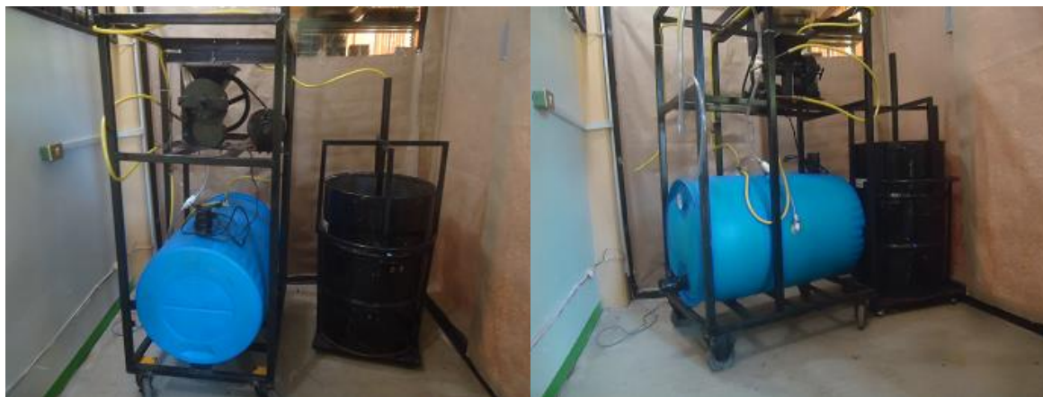
Figura 2. Biodigestor modular para casa habitación
