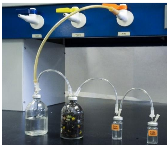
Figura 9. Montaje del sistema con aireación discontinua
