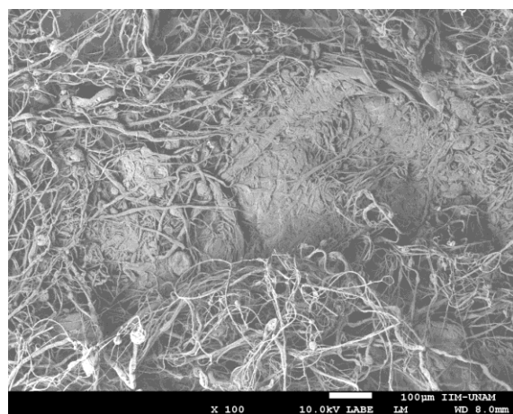
Figura 11. Fibras electrohiladas de plátano al 16% y PCL/Acetona al 99%.
