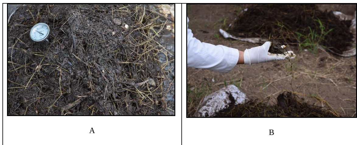
Figura 3. Evaluación de las variables de control del proceso de compostaje. Medición de la temperatura en la pila (A), Prueba de puño para medir humedad (B).
