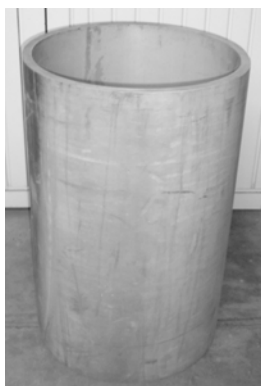
Figura 3. Cuerpo de biodigestor (PVC).
